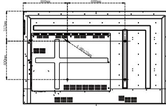
4. 在顯示器背面找到壁掛安裝螺絲孔（如圖所示）。
