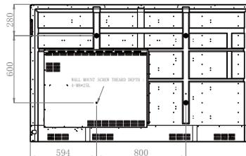
5. 依照壁掛架的安裝說明，將壁掛架安裝於顯示器，以將顯示器安裝於壁面。螺絲長度應至少超過壁掛架厚度 25 mm。請確認所有螺絲皆已鎖緊固定。(建議扭力：470 - 635N•cm)。壁掛工具的強度應足以負荷顯示器重量。
